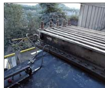
Meerlagige transportbanden zijn even sterk als de verbinding tussen de twee uiteinden. Voor de verbinding van de UsFlex werd een nieuwe techniek ontwikkeld, genaamd 'vingerverbinding'. Foto linksboven: de ingesneden vingerverbindingen Foto rechtsboven: voorbereiding van het vulkanisatieproces Foto rechtsonder: vulkanisatie aan de gang
