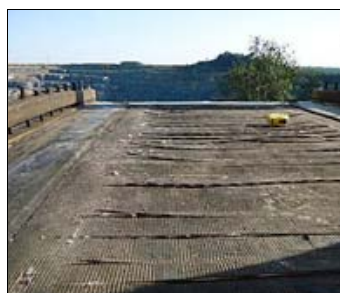
Meerlagige transportbanden zijn even sterk als de verbinding tussen de twee uiteinden. Voor de verbinding van de UsFlex werd een nieuwe techniek ontwikkeld, genaamd 'vingerverbinding'. Foto linksboven: de ingesneden vingerverbindingen Foto rechtsboven: voorbereiding van het vulkanisatieproces Foto rechtsonder: vulkanisatie aan de gang
